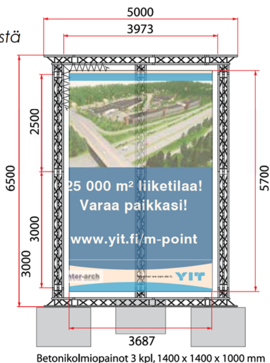
Betonikolmiopainot 3 kpl, 1400 x 1400 x 1000 mm
